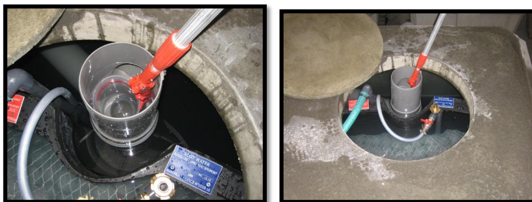
Figure 9-1: Prélèvement d'un échantillon ponctuel
